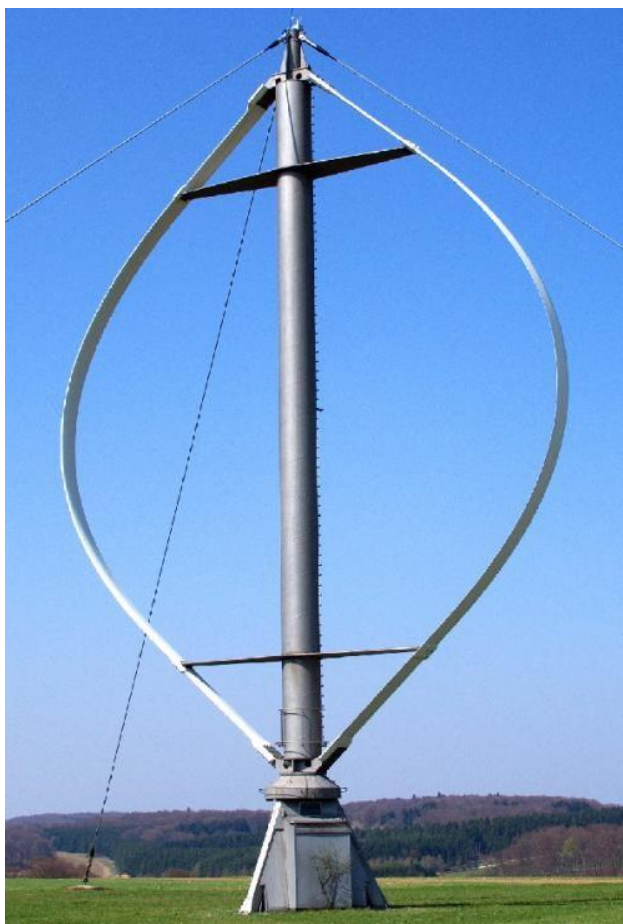
1.8 - сурет – Дарье роторының пайда болуы
